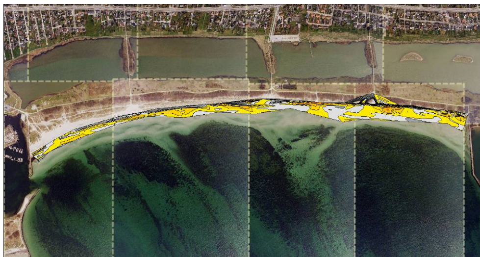
Figur 9.0 Erosion og aflejring fra 2007 til 2009. Klitfoden fosvinder (grå farver) og sandet ender i vandet (gult) og langsomt transporteres sydpå.
